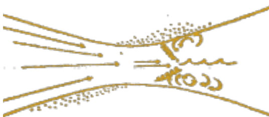
Gegenströmung und Wellen nach Flussverengung
